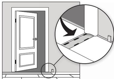
ドアまわりの施工の際は、ドア横にパネルを裏返して下地の上に置き、そして床から商品の厚みを確保しスペースをつくる為に鋸などで切り落とします。その後、商品を適切な大きさに切断し、ドア下へスライドさせ施工します。
