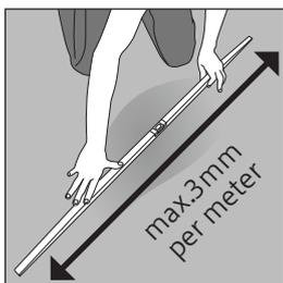
下地床の凹凸が1mあたり最大3mm以下、そして20cmあたり2mm以下であることを確認して下さい。もし下地の凹凸がその上限を超える場合、必ず平らにする為の処理をして下さい。
