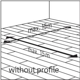
推奨する最大の部屋の大きさは20×20mです。プロファイルを使用する場所は扉部分、そして部屋の一边が20mを超える場所です。
