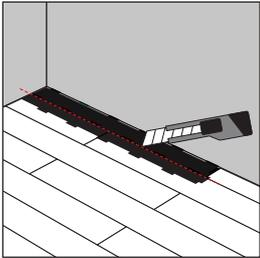
最後のパネルを施工する為には、一つ手前のパネルに重なる様に最後のパネル裏返して乗せ、重なる部分を線で引く。そこを目印に切断し、最後の部分にはめ込む。この方法は、各列の最後の部分で使用する。
