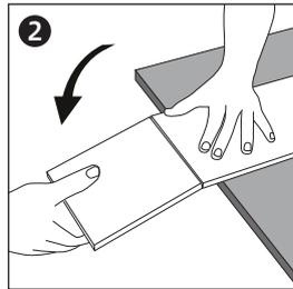
絶対にプラークを繋ぎ合わせる際に、ハンマーを使用しないで下さい。切断する際は、カッターナイフでも切断可能です。
