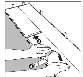
常に、次の列を開始する際は30cm以上のパネルを使用して下さい。30cm以上であれば切断後の残った端材も使用できます。
