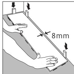
施工前に、部屋の寸法を測定して下さい。必要であれば、最初の列のパネルを切り、部屋寸法に合う様にして下さい。最初と最後の列のパネルの幅が5cmを下回らない様にして下さい。
