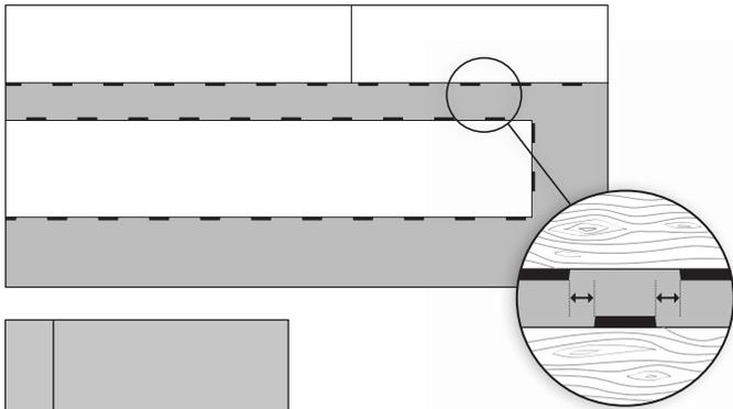
クリックは必ず、繋ぎ合わせるパネルの2つのクリックの丁度中央に位置する様に接合する必要があります。同列の2つ目のパネルからは、短辺から先に繋ぎ合せ、その次に長辺を繋ぎ合わせる。
