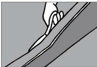
上の刃を上げないで、下の刃を使ってカットする。脱線に注意して切る。
