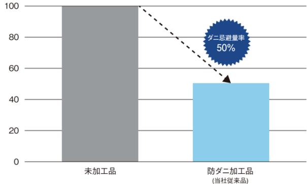
●グラフは未加工品を100とした場合 ●試験機関:(一財)カケンテストセンター ●試験方法:JIS L 1920侵入阻止法において、未加工品、防ダニ加工品、防ダニ90加工品のダニ忌避数を計測
